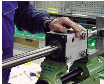
Bei der Montage der Rollringgetriebe sind Handarbeit und Fachkenntnis angesagt.
