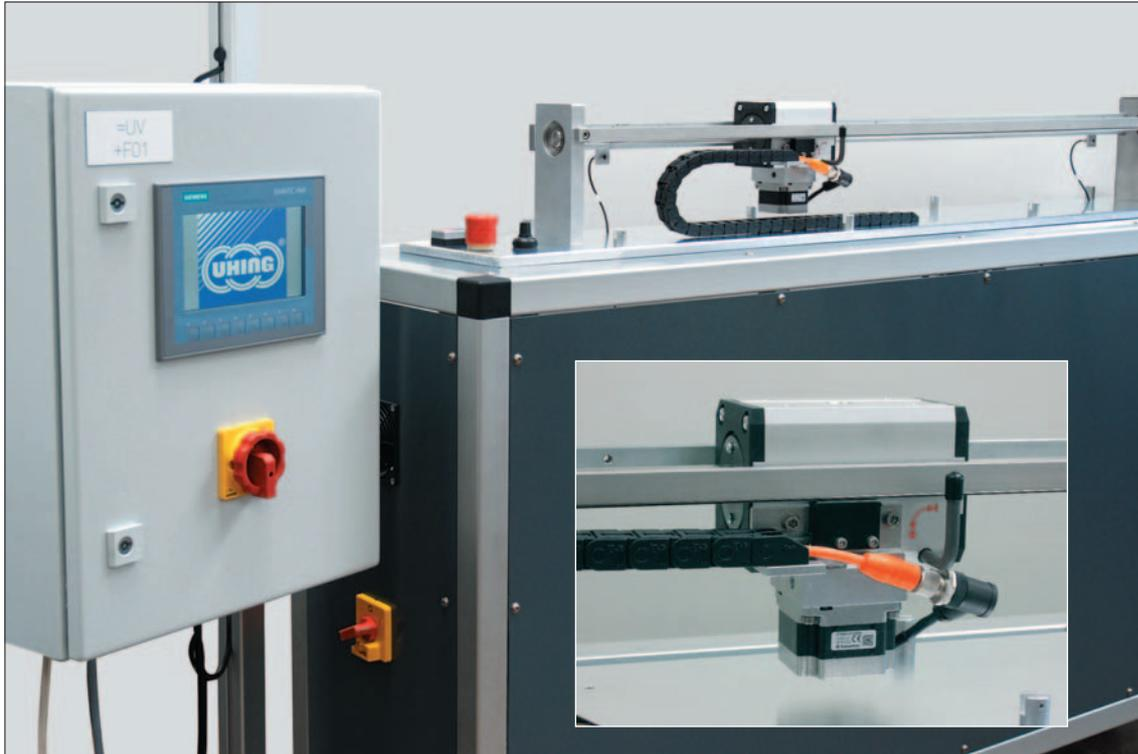
Das bewährte Rollringgetriebe ist modifiziert worden. Als Modul des **Uhing Motion Drive** sind weder der Umschalthebel noch die Skala zur Einstellung der Steigung erforderlich. Diese Funktionen werden von einem Schrittmotor und einer Siemens S7 Steuerung übernommen, die eine anwenderfreundliche Bedienung sowie flexible und variable Einstellungen in einer selbsterklärenden und logischen Menüführung bietet.
