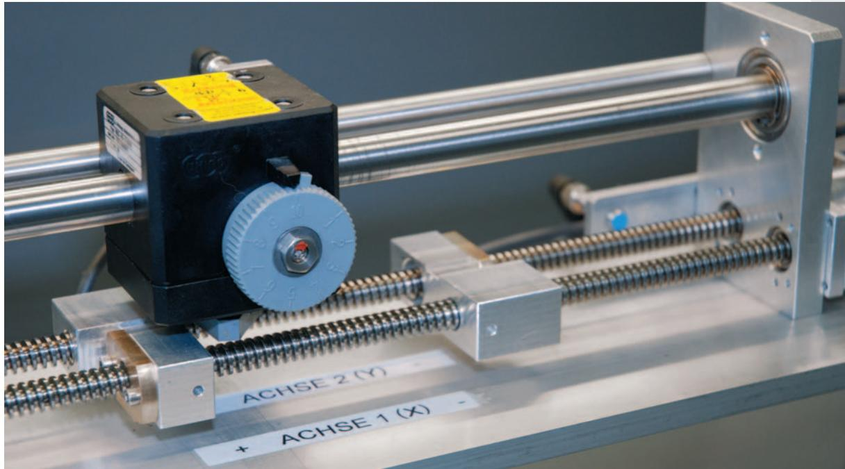
Der Einrichtbetrieb erfolgt über ein elektronisches Handrad. Im Betrieb sind über das Handrad Korrekturen möglich. Der Sensor misst die Anzahl der Hübe und ver-
