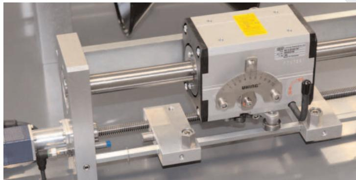
Los nuevos topes de Uhing regulables electrónicamente, es decir, los **Uhing Moveable Endstops**, ofrecen una aplicación sencilla para obtener resultados rápidos y correctos en bobinas bicónicas.
